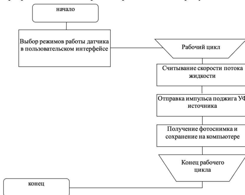
Рисунок 1 – Блок-схема алгоритма программы управления датчиком наличия и концентрации нефтесодержащих примесей
