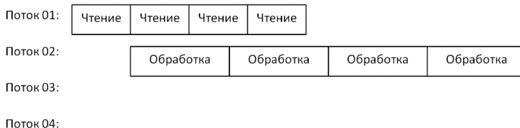
Рисунок 1 – Схема работы исходного алгоритма
