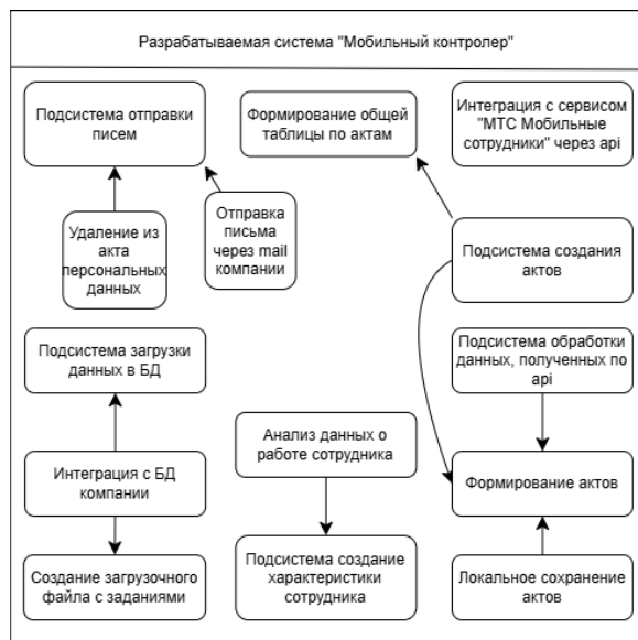
Рисунок 2 – Модульная архитектура разрабатываемого комплекса.
